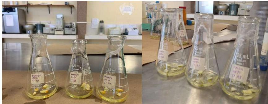
Nota: La presente imagen muestra los experimentos realizados para la extracción de los compuestos bioactivos de residuos de naranja y limón. Fuente: Propia
