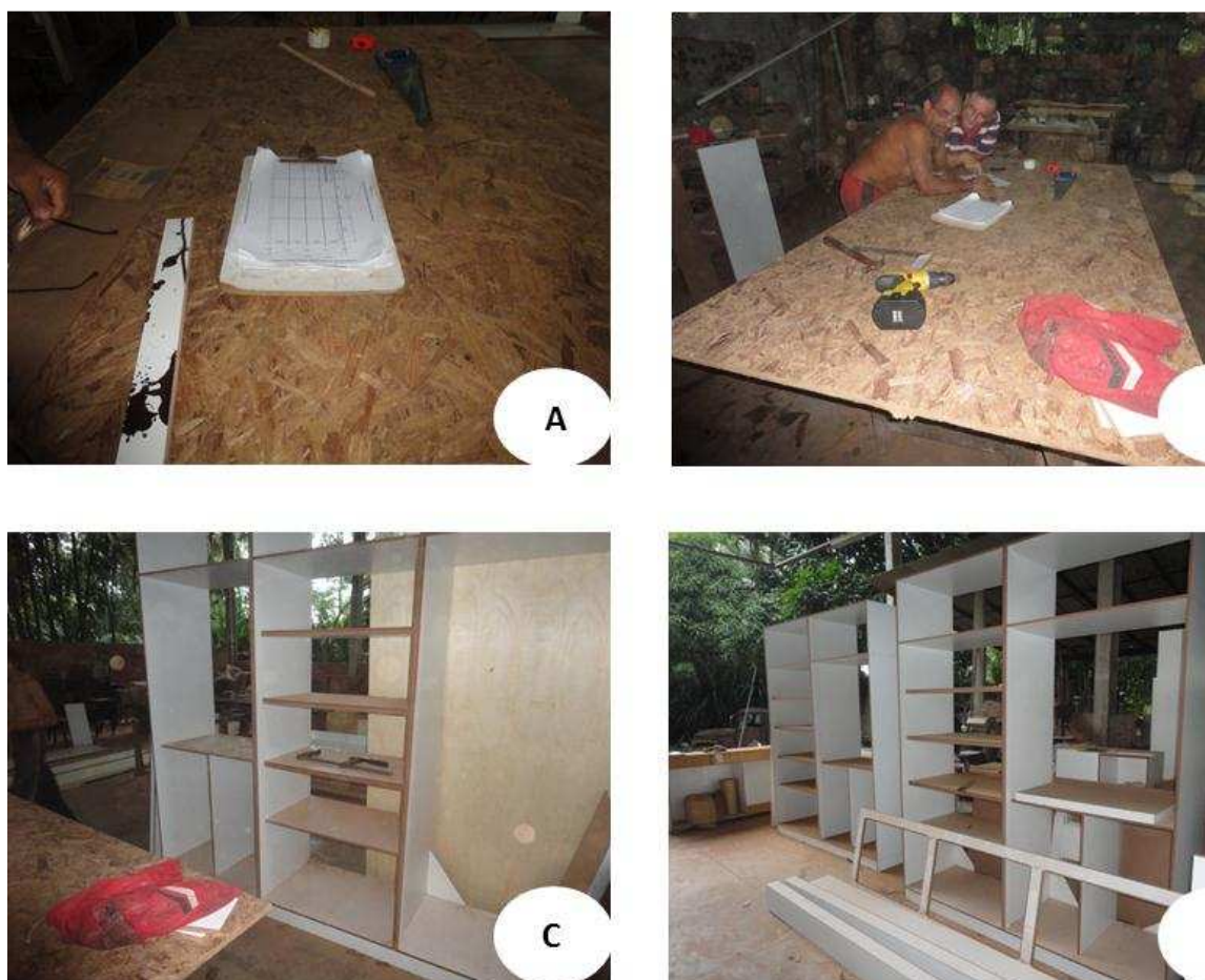
Figura 4. Aspectos gerais dos produtos. A e B- Planejamento e elaboração dos móveis; C- Armário produzido em MDF laqueado; D- Armários em fase de montagem.
